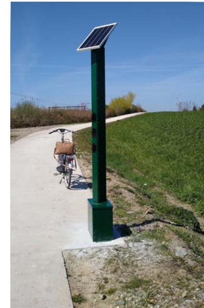
• TOTEM: O sensor, painel solar, modem e bateria estão integrados numa elegante caixa de aço pintada que é fácil de instalar, robusta e completamente autónoma.
