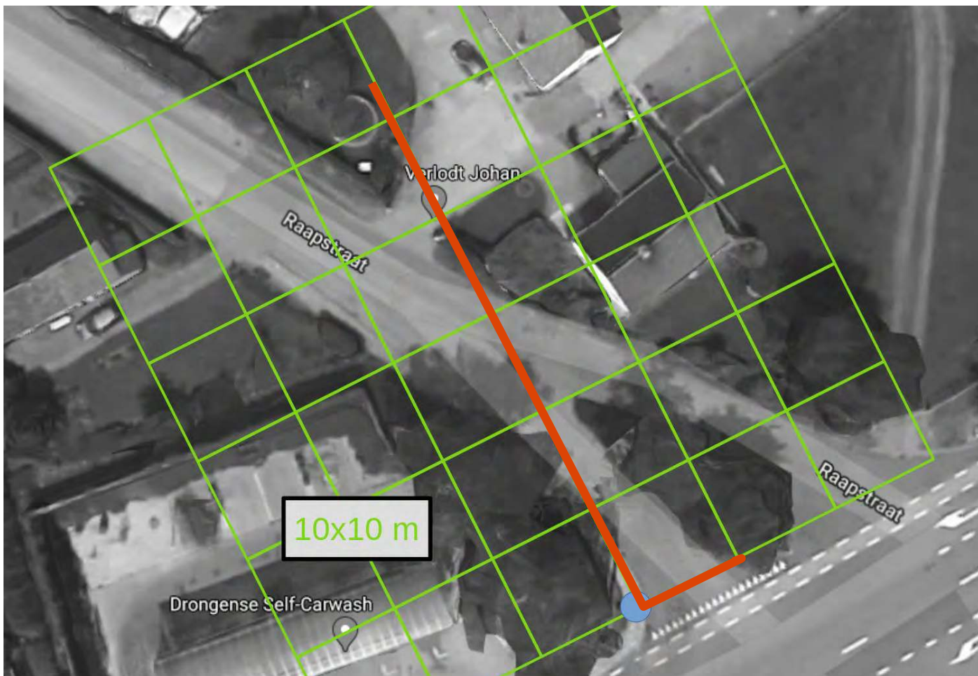
Figura 20: eixo de detecção numa estrada não rectilínea
