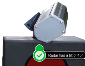
Abbildung 13: Ansicht von der Vorderseite des Ampelkopfs: das Radar ist geneigt
