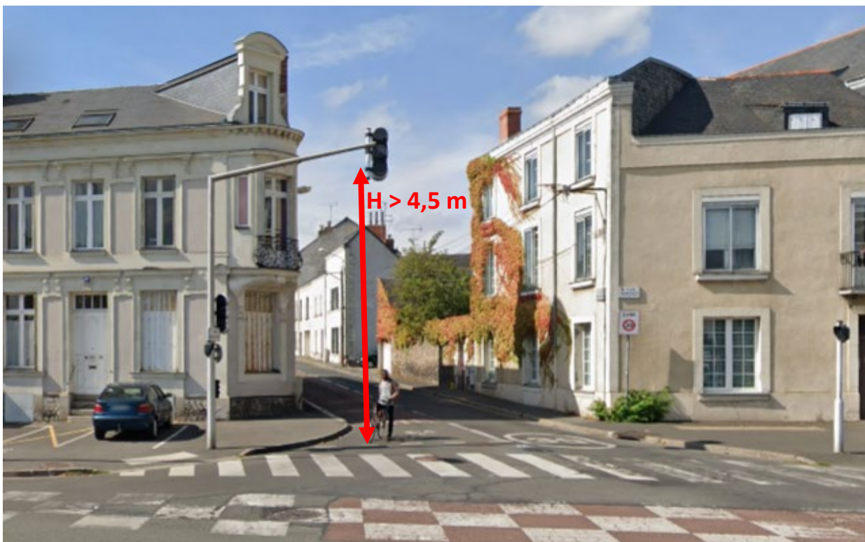
Abbildung 23: über der Straße Installation (horizontale Mast) - überblick
