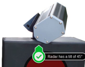
Figura 11: vista frontale superiore del semaforo. Il radar inclinato verso il marciapiede
