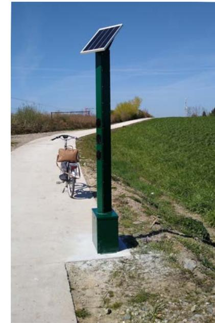
• TOTEM : le capteur, le panneau solaire, le modem et la batterie sont intégrés dans un habillage élégant en acier peint, facile à installer, robuste et totalement autonome.
