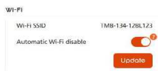
Figure 25 : désactiver automatiquement le Wi-Fi après 60 minutes d'inactivité
