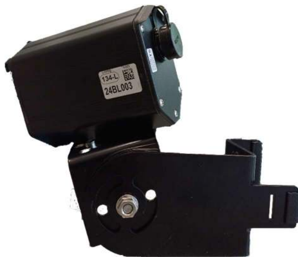
Figure 14 : installation pour détection pied de feu, radar à droite dans le sens de déplacement des véhicules - 20° vertical/- 30° horizontal
