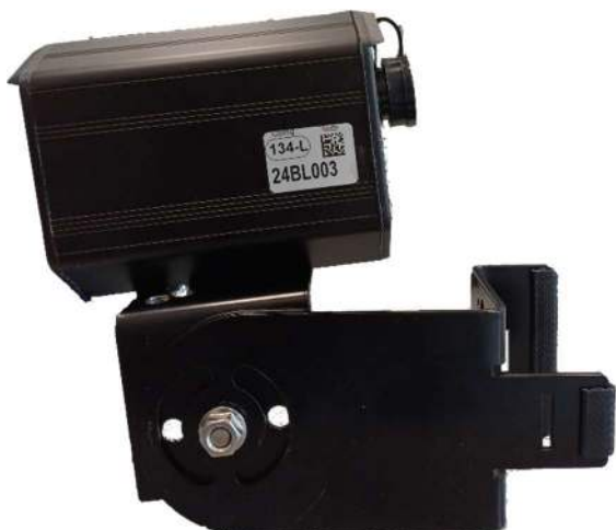
Figure 13 : installation pour détection distante < 5° vertical/0° horizontal
